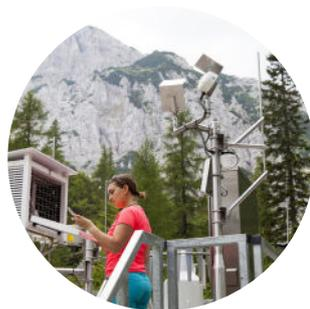
**Les stations météorologiques** au sol mesurent la température, la vitesse et la direction du vent, la quantité d'eau qui tombe, l'ensoleillement.
