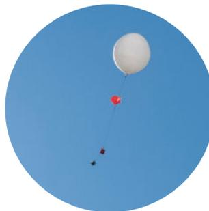
**Les ballons sondes** sont envoyés, ils mesurent la température de l'air jusque dans la haute atmosphère, mais aussi la vitesse du vent...
